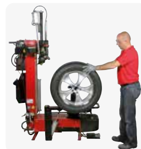
Elevador ergonómico. Permite posicionar fácilmente todas las ruedas en el autocentrante (accesorio bajo pedido, solamente A50). Elevador ergonómico para posicionar com facilidade todas as rodas no autocentrante (acessório a pedido, unicamente A50).
